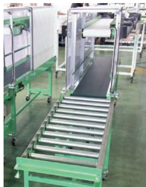
※傾斜をつけて自重でストックさせます。
