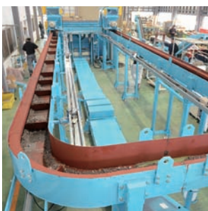
R部(スクレーパーコンベヤー)
