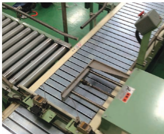
乗継ぎ部 プッシャーにて乗継ぎ (スラットコンベヤー→ローラーコンベヤー)
