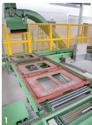
1.ラウンドコンベヤー スクラップBOX集積装置 2.工場外(スクラップヤード)への搬送
