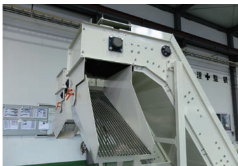
シュート部 すのこシュートで細かいものと分けることができ、更に微妙な角度調節もできます。
