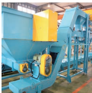
乗継部(ヒンジコンベヤー)
