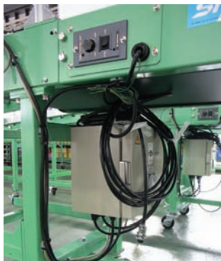
制御部(モーター内蔵型スピー ードコントローラー付)
