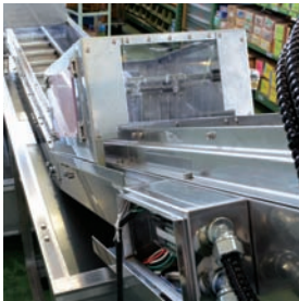
傾斜部エアブロー装置
