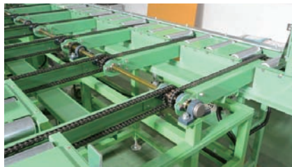
移行装置 長短によってラインを切り換えます。
