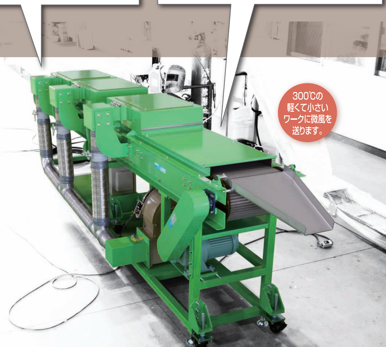
■駆動ドラム部(ドラムにヘビイカルゴムライニングをし、ネットのグリップ力を強化。)
