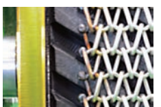
■駆動ドラム部(ドラムにヘビイカルゴムライニングをし、ネットのグリップ力を強化。)
