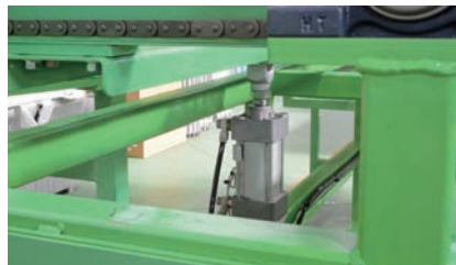
シリンダーによる上・下機構 全てのチェーンコンベヤーの乗継部を上下することでワークを移載します。
