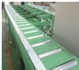
ワーク搬入部（駆動ローラーコンベヤー）プレス工程に合わせ高速度で搬送します。
