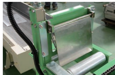
ストッパー装置 長尺の際は取り外しそのまま直送。短尺の際はストッパーで止め、チェーンコンベヤーで受け取ります。
