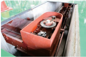
⑤支流コンベヤー(③)からメインコンベヤー(②)への乗継部
