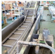
冷却装置付リッター搬送 コンベヤー (ALL SUS仕様)
