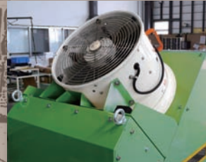
■インバーター付送風機 (送風量を調整できます)
