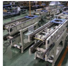
治具搬送装置 (高技術搬送装置)
