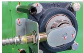
■回転検出センサー（コンベヤーの稼動をチェックします）
