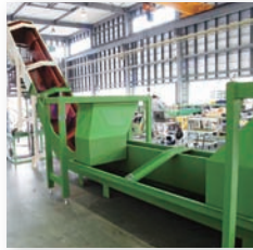
スクラップ搬送用コンベヤー (プレス加工工場向)
