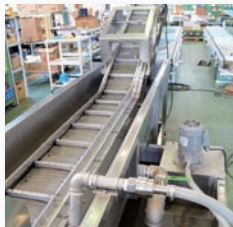
冷却装置付リッター搬送 コンベヤー (ALL SUS仕様)
