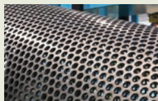
■小さいものを選別し落下させる(リサイクル材)
