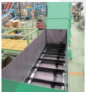
③ トロンメルからの乗り継ぎコンベヤー ※切出しコンベヤー (SCO型)
