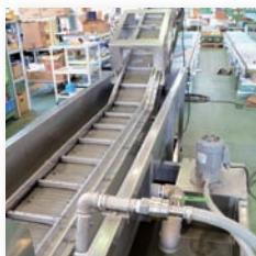
冷却装置付リベッター搬送 コンベヤー (ALL SUS仕様)
