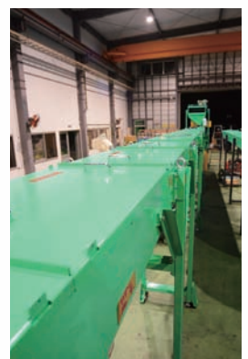
④ 搬送面のシャッター部 (6ヶ所) ※開閉付 ④ ブリケットマシンへの切粉 供給コンベヤー (SCF型)
