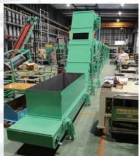
③ トロンメルからの乗り継ぎコンベヤー ※切出しコンベヤー (SCO型)
