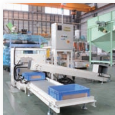
パレット供給コンベヤー (段バラシ)
