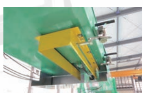
④ 搬送面のシャッター部 (6ヶ所) ※開閉付 ④ ブリケットマシンへの切粉 供給コンベヤー (SCF型)
