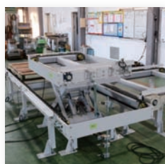
チェーンコンベヤー (直角移載用リフター付き)
