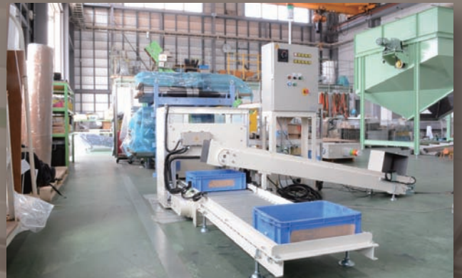
パレット供給コンベヤー(段バラシ)
