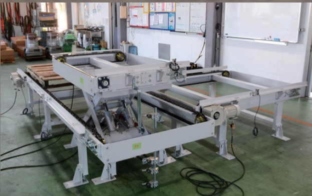
チェーンコンベヤー(直角移載用リフター付)
