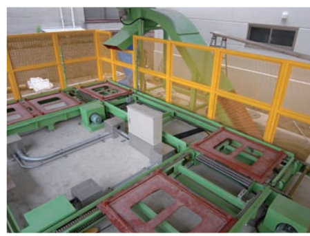
■ スクラップ BOX 移載装置 ※ラウンドコンベヤー スクラップBOX 集積装置
