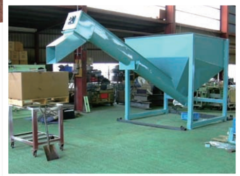
■ アルミ切粉搬送 (U型スクリュウコンベヤー ホッパー付)
