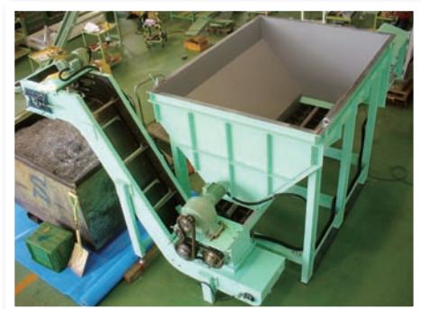
■ アルミ切粉搬送 (スクリュウ・スクレーパーコンベヤーの組み合わせ)
