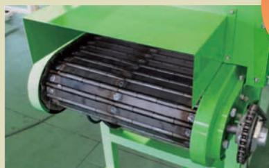
ヒンジベルト (ハイテン材補強)
