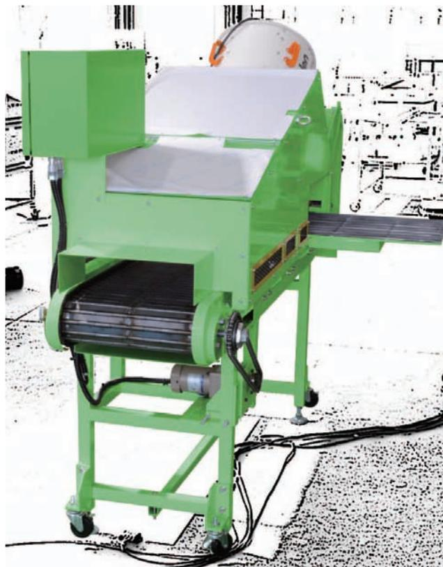
高熱な上にワークの重量があるので、ヒンジベルトにハイテン材の補強をしました。北海道仕様のため、外気温を取り入れ(吸引)ワークを効率的に冷ましていきます。テール部に投入口を設け、コンベヤーを覆うことで、より吸引効果を高めました。
