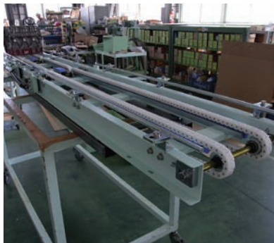
■全体図 エンジブロックを手作業で移載します。
