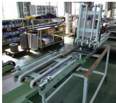
■跳ね上げ機構 通路確保のため、跳ね上げ機構付の仕様としました。
