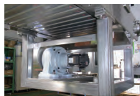
■サーボモーター仕様 (コンベヤー上で正確な正逆運転をさせます)
