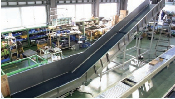
■全体図 (湿気があるため、アルミフレーム・ステンレスカバーを採用しました)
