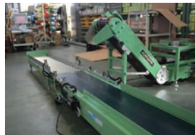
■空箱供給コンベヤー
