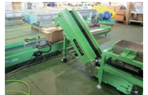
■製品搬送コンベヤー
