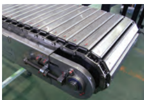
■従動部とスラット板 (重量物のため板厚3.0tでネジ止め)
