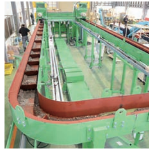
R部(スクレーパーコンベヤー)
