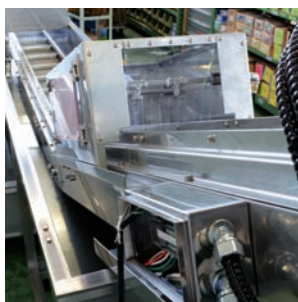
傾斜部エアブロー装置
