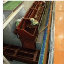
ダイカスト加工後のスクラップ回収ライン (支流コンベヤ:大量ワーク対応)
