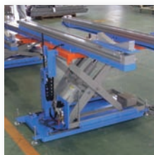
タンク搬送・昇降装置 (特殊コンベヤ)
