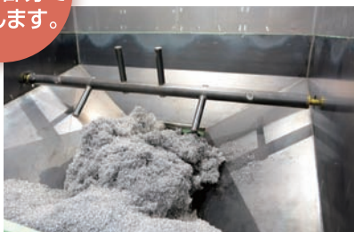
■ブリッジ避け(攪拌装置内部)
