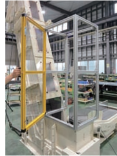
■安全カバー(ロボット稼働範囲の安全柵)
