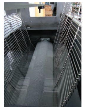
■ネット洗浄装置
