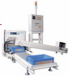
●パレット供給コンベヤー (段バラシ)
