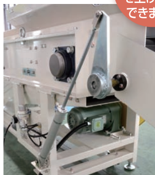
■排出部 (シュート跳上時) シリンダーで開閉します。
