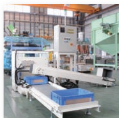
パレット供給コンベヤー (段バラシ)
