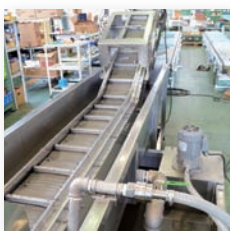
冷却装置付リベット搬送 コンベヤー (ALL SUS仕様)
