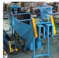
ホッパー付 特殊ヒンジコン ベヤー(ブリッジ防止機構付)
