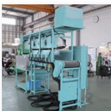
精密プレス部品の冷却用 コンベヤー(300°⇒80°)
