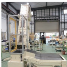
急傾斜コンベヤー(安全柵付)
