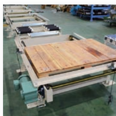
チェーンコンベヤーとロー ラーコンベヤーの組合せ
