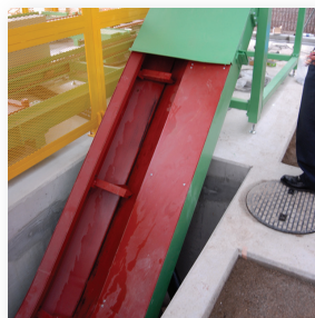
プレス加工後のスクラップ回収ライン (本流コンベヤー：省人化)
