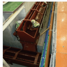
ダイカスト加工後のスクラップ回収ライン (支流コンベヤー：大量ワーク対応)
