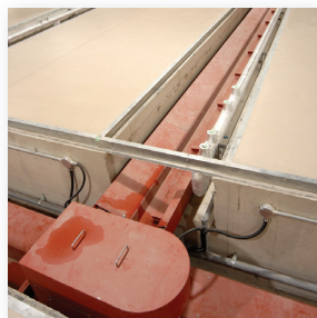
プレス加工後のスクラップ回収ライン (支流コンベヤー：省人化)
