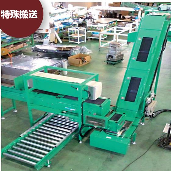
高温のバネをファンで冷却した後、上方へと搬送して左右に振分けます。
