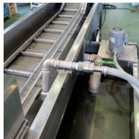
水冷循環式水槽
